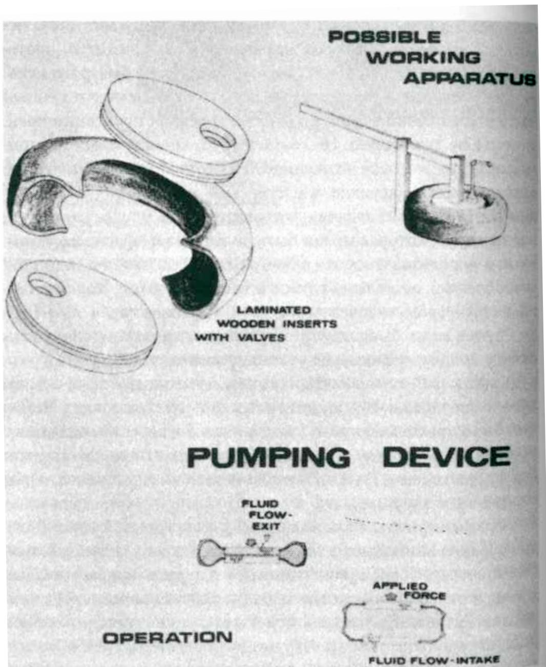
Одно из двадцати исследований по использованию старых шин, которыми изобилует страны Третьего мира. Два ирригационных насоса были сделаны и проверены. Дизайн Роберта Тоуинга, студента Университета Пердью. (Текст на рис.: ламинированные деревянные вставки с клапанами; УСТРОЙСТВО НАСОСА; выход жидкости; прилагаемая сила; поступление жидкости)
